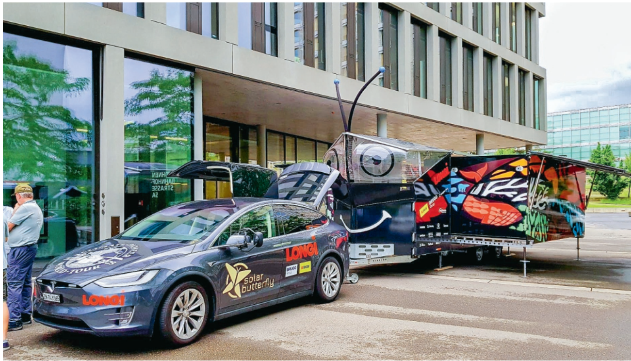
Der 18 Meter lange «Solar Butterfly» – ein Tiny House auf Rädern – wird von einem Elektroauto der Marke Tesla gezogen. Die Energie für die Fahrt kommt vom Solardach, den aufgeklappt 80 m 2 grossen Solarflügeln des «Schmetterlings» BILD: ZVG
